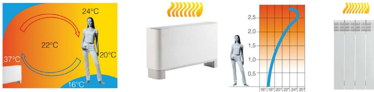
Рис. 2. Распределение температуры при радиаторном отоплении
